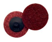
Круги изготовлены из армированного пространственного нетканого синтетического материала, что обеспечивает равномерную обработку поверхности. Применяются для подготовки пластиковых деталей перед ремонтом, зачистки следов точечной сварки и фланцев, удаления легких окислов, а также транспортировочного грунта с новых деталей. Эффективны для понижения рисок на алюминиевых, стальных, железных поверхностях и на поверхностях из нержавеющей стали.
