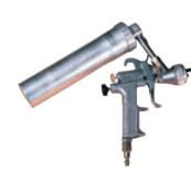
Легкий и простой в обращении пневматический пистолет для нанесения однокомпонентного распыляемого герметика. Регулировкой давления воздуха и количества подаваемого герметика можно получать различную текстуру покрытия — от гладкого до текстурного.
